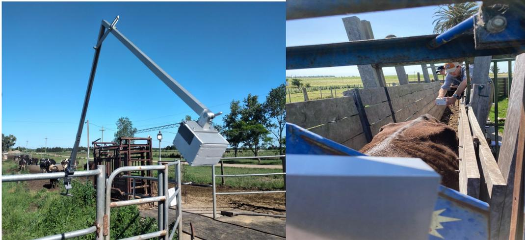
Se puede observar en las figuras anteriores, en lo que respecta a las figuras del dispositivo cond Corp con y sin soporte, en el experimento se utilizó sin soporte, se lo sujeto con las manos a una altura deseada para lograr la mejor imagen posible en busca de la correcta clasificación de la condición corporal.
