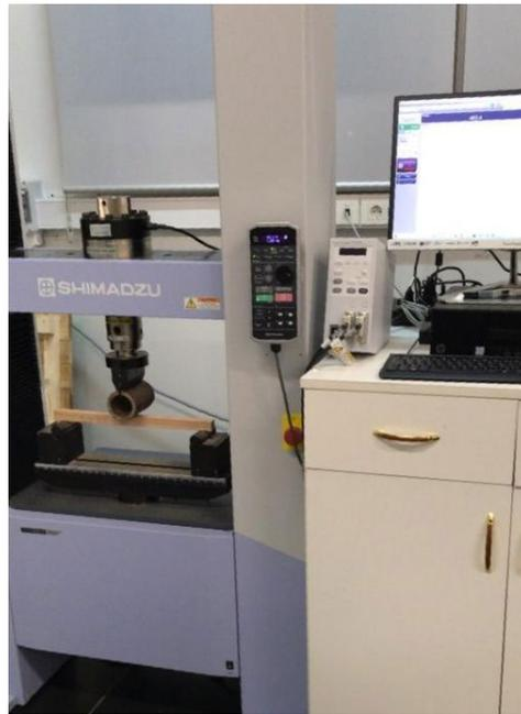
Figura Nro. 13. Vista Máquina universal de ensayos Shimadzu, modelo AGS – 100, para determinación de MOE y MOR.
