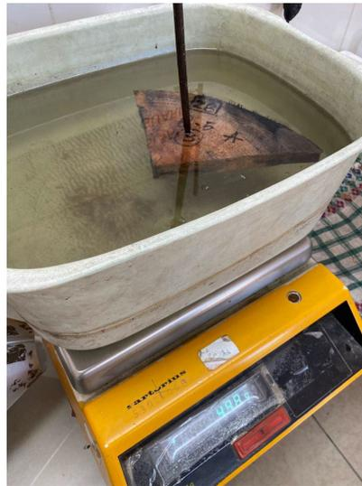
Figura Nro. 9. Medición de volumen de discos para determinación de densidad básica.
