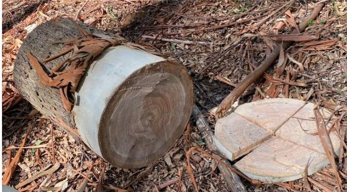
Figura Nro. 2. Extracción de discos para determinación de densidad básica de la madera.
