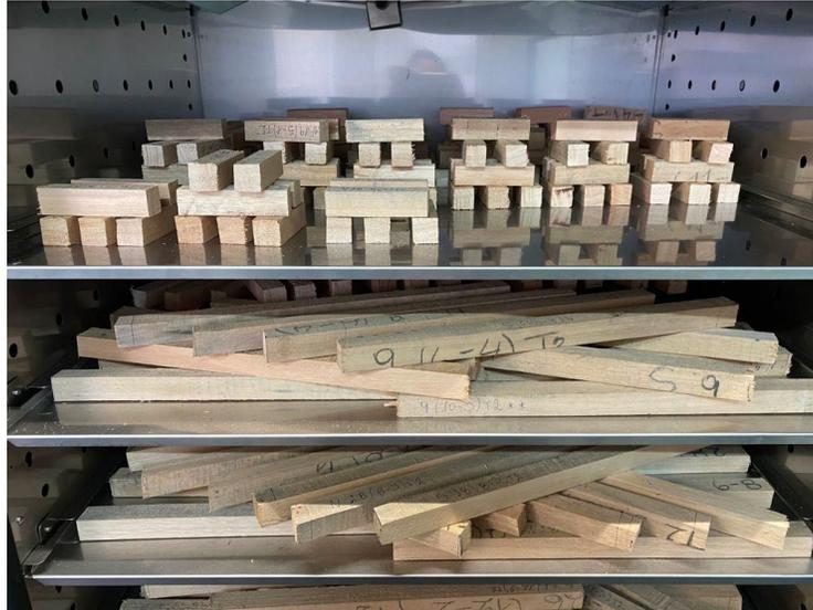
Figura Nro. 7. Cámara de climatización para acondicionamiento de probetas.
