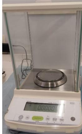
Figura Nro. 11. Vista de balanza analítica para medición de peso de probetas.
