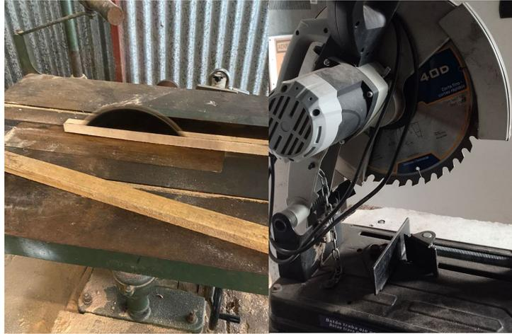
Figura Nro. 5. Vista de Sierra circular de mesa (izquierda) y Sierra sensitiva (Derecha) para confección de probetas
