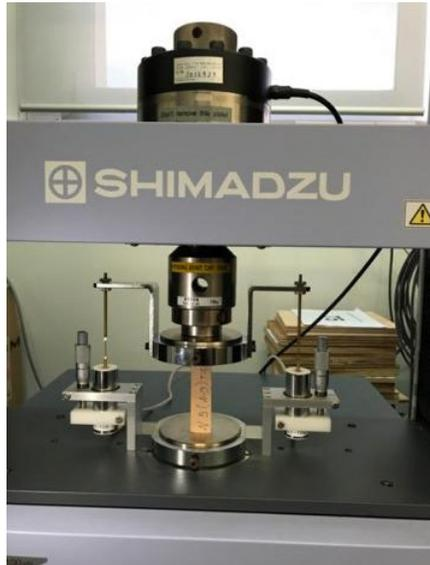
Figura Nro. 15. Vista de medición resistencia a la compresión paralela a la fibra.
