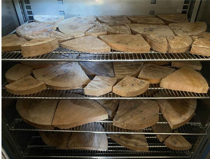
Figura Nro. 10. Estufa para secado de discos a 105° para determinación de densidad básica.
