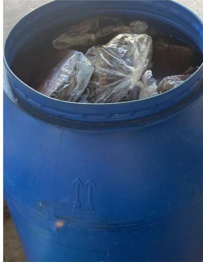
Figura Nro. 8. Saturación de discos en agua para determinación de densidad básica de la madera.
