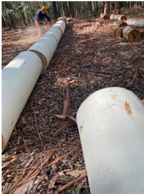
Figura Nro. 3. Trozado del fuste para extracción de muestras para propiedades de la madera.
