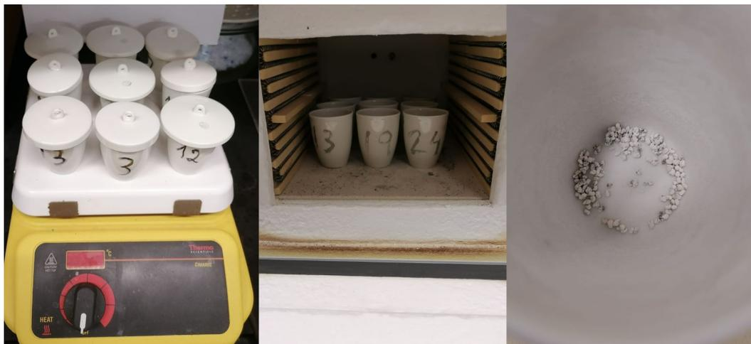
Nota. De izquierda a derecha: 1. Crisoles en plancha caliente. 2. Mufla para incineración 3. Fracción ceniza de polen de *B. napus*.
