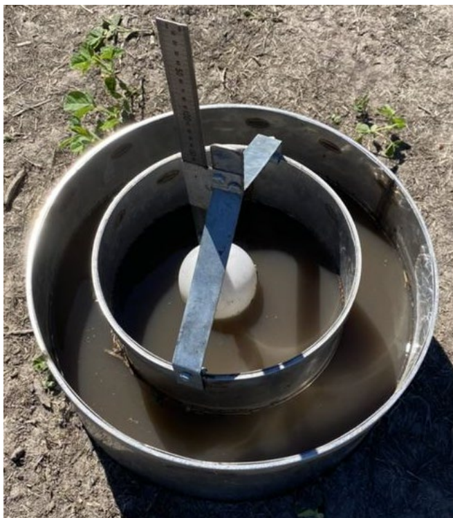
Figura 14 Infiltrómetro de doble anillo
