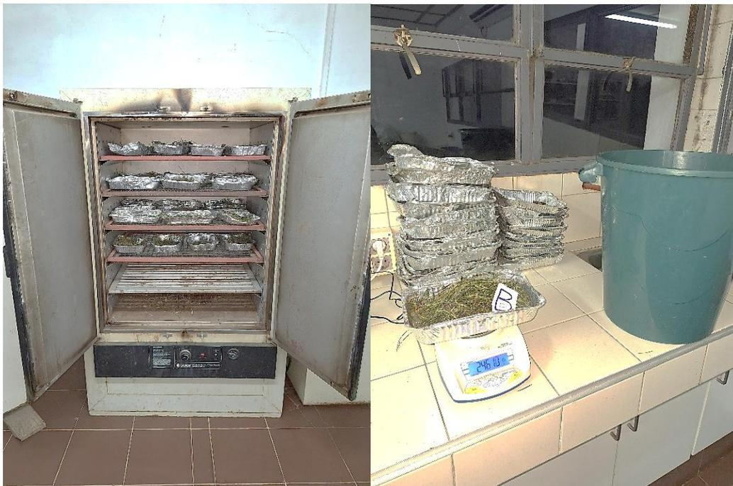
*Nota.* Izquierda: muestras secas en horno de secado. Derecha: pesaje de muestras secas
