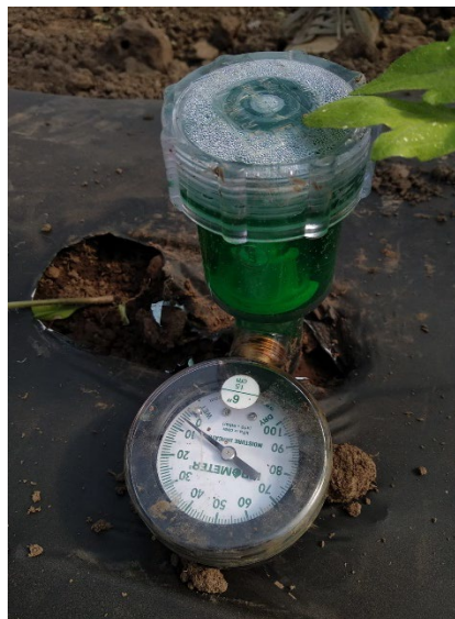
Figura N° 11: Tensiómetro instalado en la parcela a 30 cm de profundidad.
